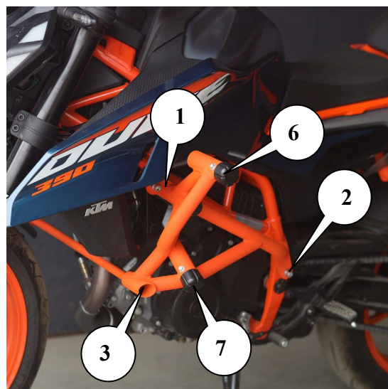
Рис 2 Установленная клетка вид слева (требуется доработка пластика)
