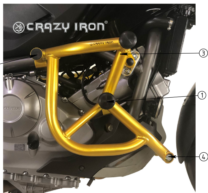
Рис 2 Установленная защита, вид справа.
